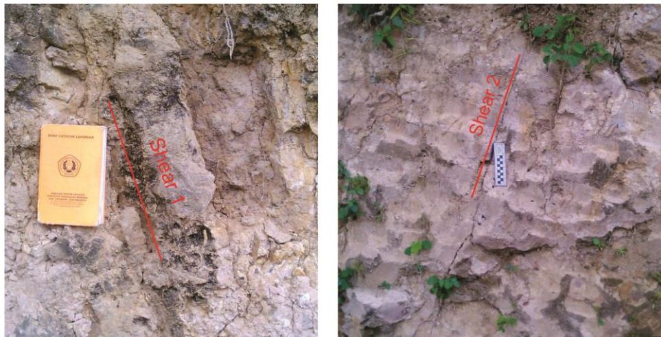
Gambar 13. Foto kenampakan kekar shear 1 dengan arah lensa N 268°E dan shear 2 dengan arah lensa N 272°E
