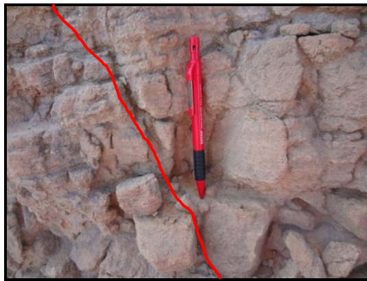
Gambar 6. Kenampakan struktur kekar di lokasi pengamatan 35.
